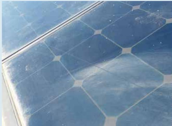
Bild 2: Modul mit beschädigter Oberflächenbeschichtung.
