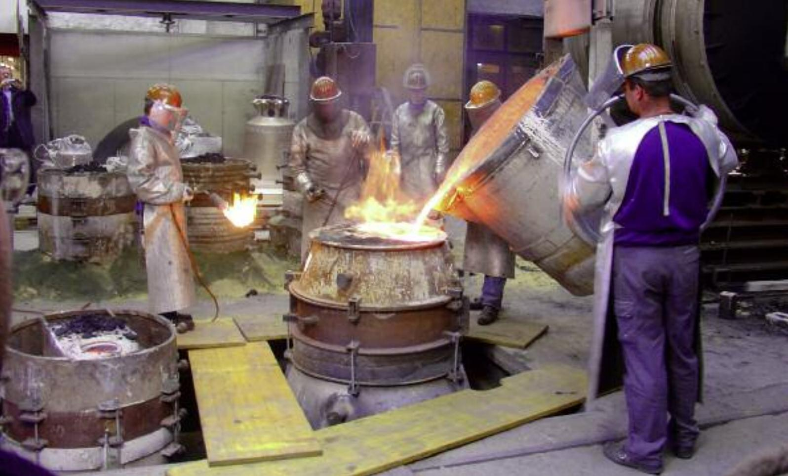
*Höchste Konzentration und Ruhe war während des Giessens der Glocke angesagt. In diesem Moment muss alles sehr genau ausgeführt werden.*
