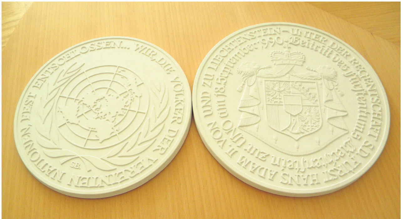
Diese Gipsplatten, entworfen von Sepp Bucher, dienten als Vorlage für die Herstellung der Prägestempel. (Fotos: PM)
