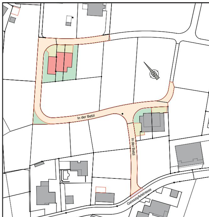
Diese Ausbautetappe erstreckt sich von der Geisszipfelstrasse auf einer Länge von 305 m bis zu den letzten Wohnhäusern in der Betzi. Auf 155 m wird die Erschliessungsstrasse mit dem kompletten Werkleitungsbau, der Koffierung, den Randabschlüssen und einem Belag neu gebaut. Auf den weiteren 150 m Erschliessungsstrasse werden nur noch die Randabschlüsse und der Belag erstellt, da auf diesem Abschnitt die Werkleitungen und der Strassenkoffer bereits vorhanden sind.
